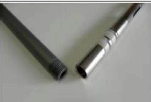
Соедините пакер с инъекционной трубкой.
